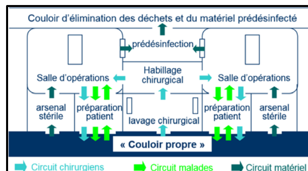
Figure37 : salle d'opération à double circuit.
