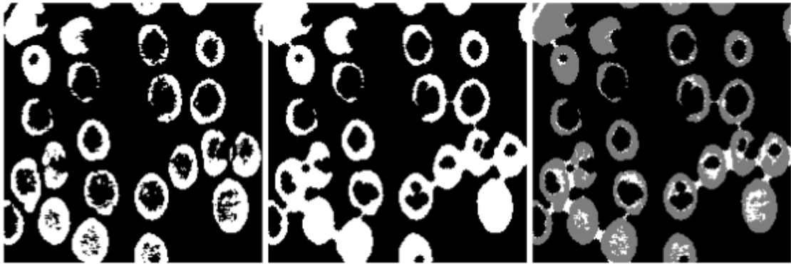
Figure 2.8 : Exemple de fermeture binaire (de gauche à droite : image initiale, fermeture par un disque de taille 3, différence : en blanc, les parties rajoutées par la fermeture).
