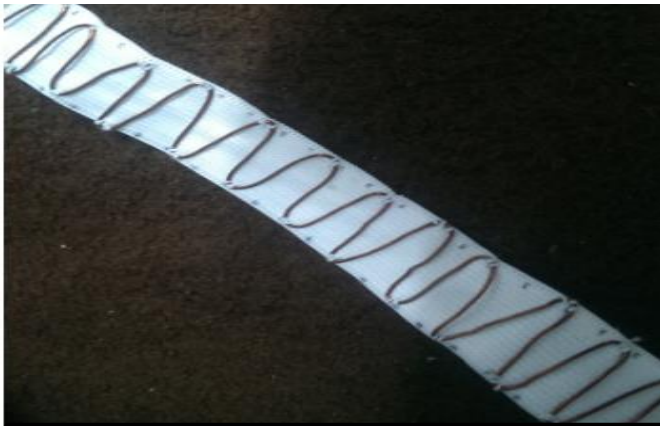
Figure 2.3 Bobine par un seul fil en une seule ligne
