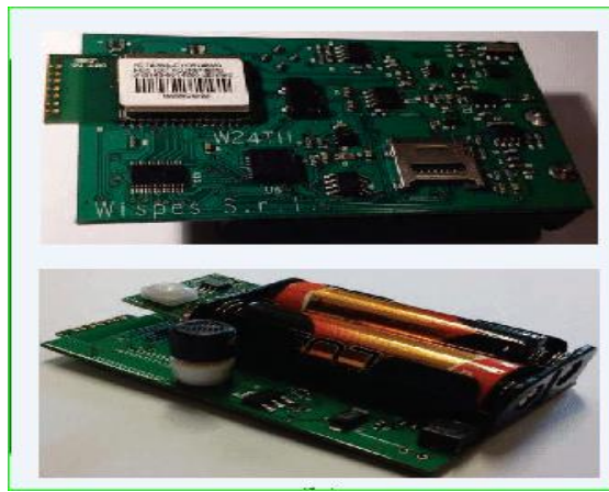
Figure 2.2: Schéma et La carte Jennic qui contient le module Zigbee.
