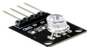
Figure 3.22: LED RGB avec trois couleurs.
