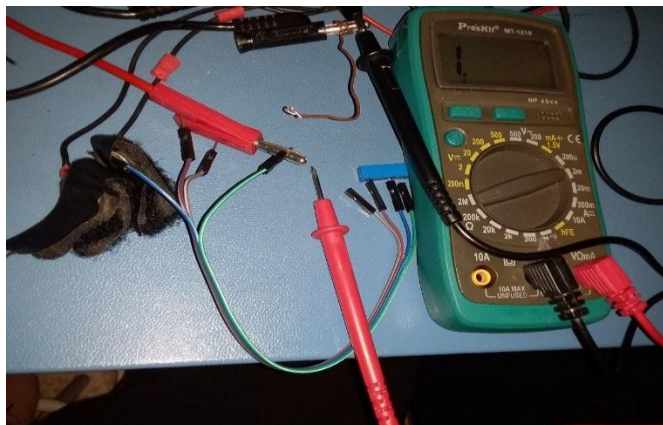
Figure 3.3: mesure de la tension en fonction de la résistance (test des électrodes)
