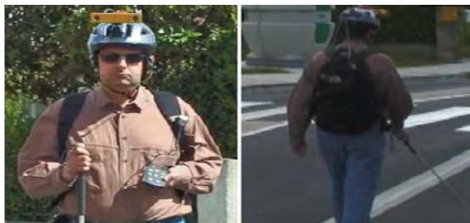
Figure I.5: Dispositif d'assistance basé sur la technique du GPS et de la vision artificielle.
