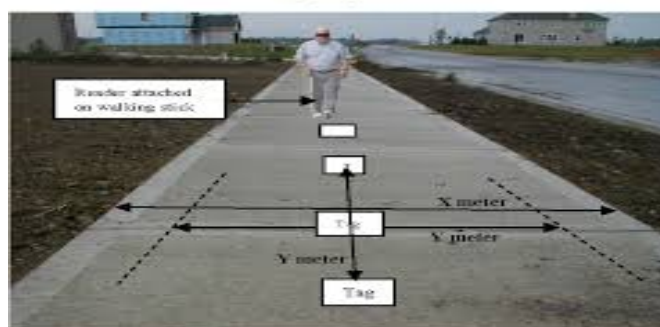
Figure I.4 : système de bâton de marche d'identification par radiofréquences.
