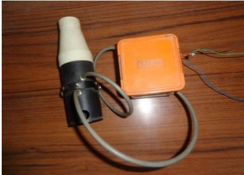
Figure 34 Image réal de notre capteur PTG à pression différentielle.
