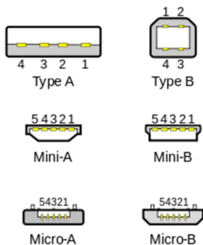
Figure II.3: Différents types de connecteurs USB
