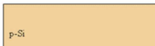
Etape 2 : Diffusion plein plaque de phosphore de  $\text{POCl}_3$  à  $950^\circ\text{C}$  pendant 20 minutes ; redistribution à  $1050^\circ\text{C}$  pendant 60 minutes sous oxygène (formation d'oxyde sec).
