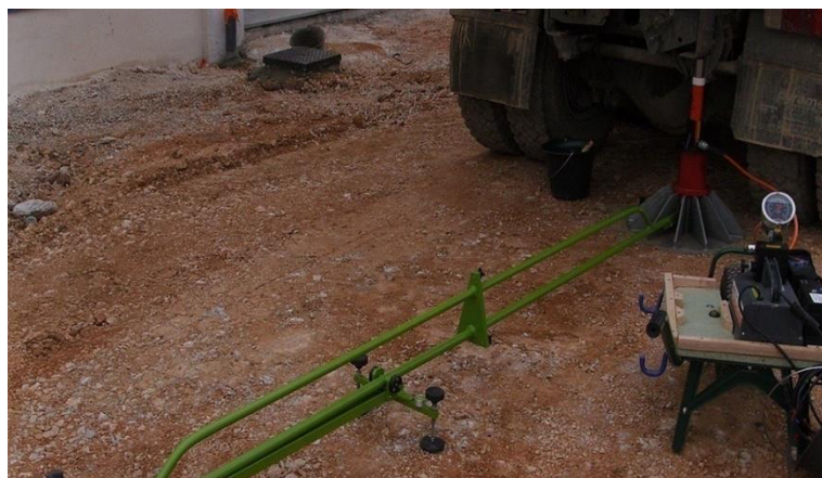
PHOTO 4.2 : ESSAI À LA PLAQUE (NF P 94-117-1)
