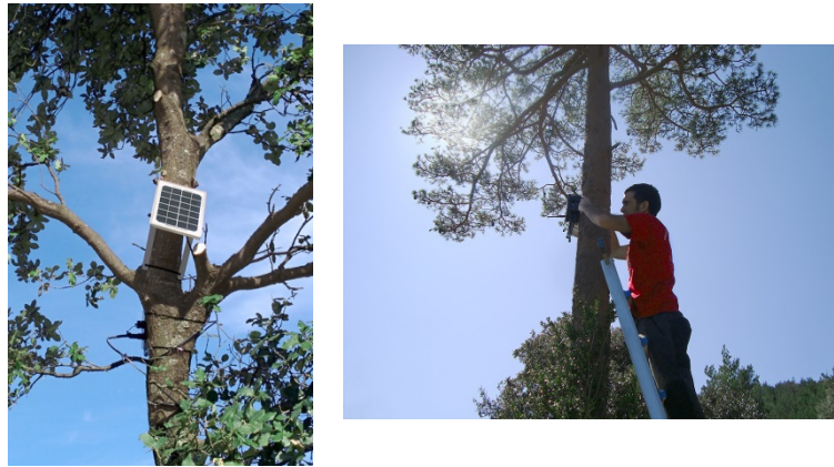
Figure 1.9 : Installation des capteurs Libelium en forêt pour détection des incendies (Le nord de l'Espagne)
