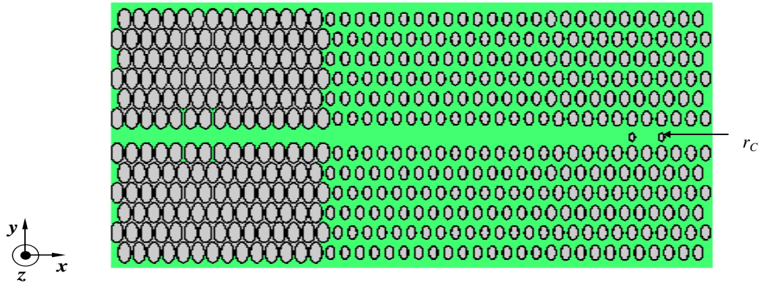
Figure III.17: Deuxième topologie d'un filtre sélectif à base des CPs-2D centré à \lambda= 1.55 \mu\text{m} avec l'ajout de deux trous de rayon normalisé r_c=0.17 .
