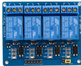
Figure IV.2 : Module de relais à 4 canaux
