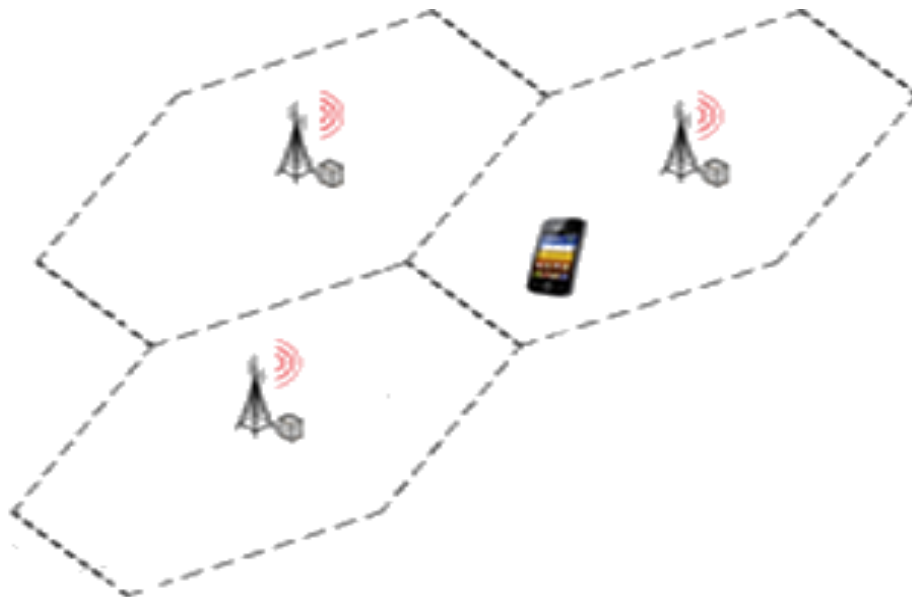
Figure I.2:Technique de la localisation par GSM [1].
