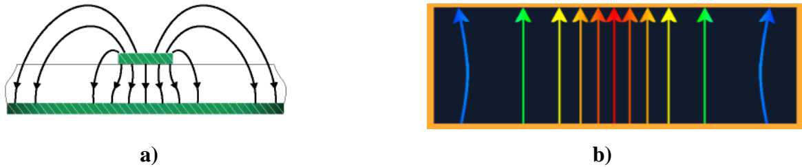
Figure I.11 : Lignes de champs a) dans une ligne micro-ruban b) dans un guide d'ondes rectangulaire
