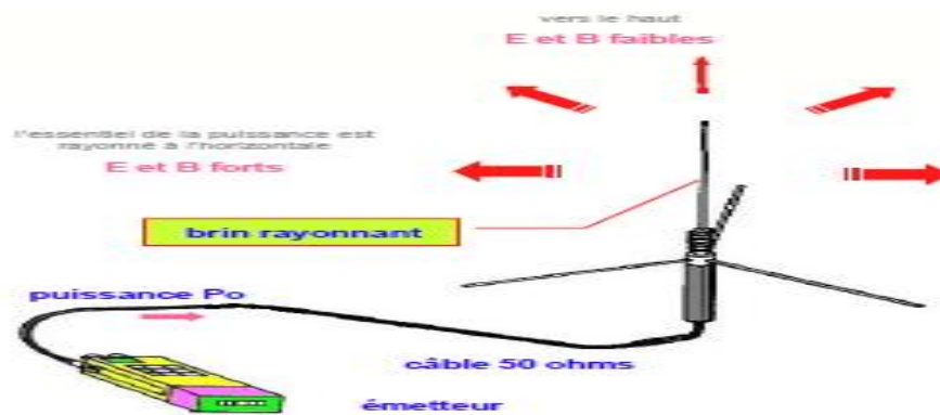
Figure I.4. Le rayonnement d'une antenne.
