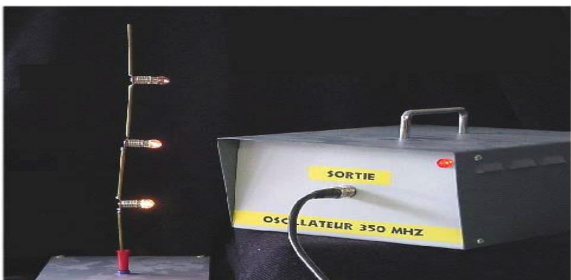
Figure I.3. La circulation d'un courant dans une antenne.
