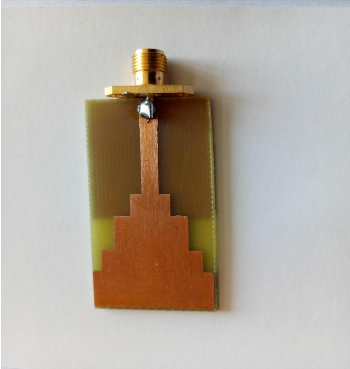
**Figure III.12** Antenne microruban réalisé au laboratoire de recherche
