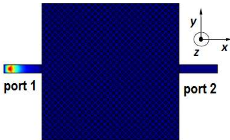
Figure III. 7 : Répartition de champ électrique E_z dans un CP-2D sans défaut à motif triangulaire.
