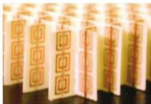
Figure II.15 : Prototypé du métamatériau 2D, les résonateurs en cuivre sont gravés sur un substrat en fibre de verre, les rubans sont gravés sur la face opposée [66].
