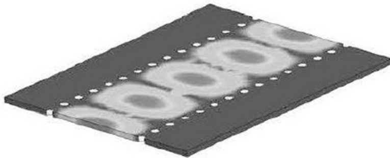
Figure I.6: Amplitudes du champ électrique en mode fondamental dans une structure SIW.
