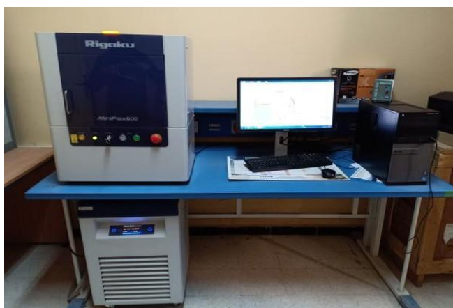
Figure 4: l'appareil DRX MINIFLEX 600.
