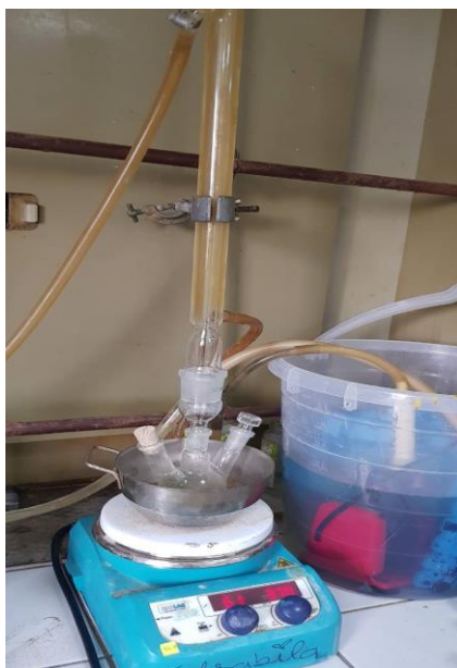
Figure 9: montage de l'oxydation par \text{H}_2\text{O}_2 .
