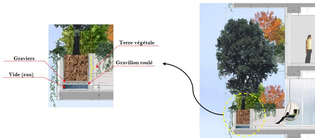
Figure n° 81: Schéma explicatif d'un bac sur dalle.
