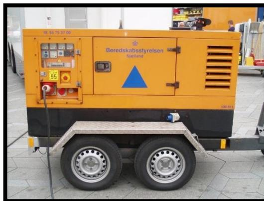
Figure 259: groupe électrogène<sup>264</sup>
