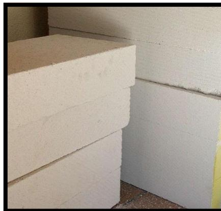
Figure 18: Blocs standards de béton cellulaire<sup>30</sup>
