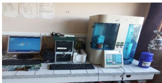
Figure II.5. Appareil de mesure BET « Nova1000 »
