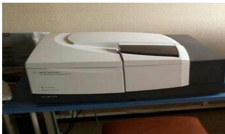
Figure II.3 : Spectrophotomètre Infra-Rouge à transformée de fourrier (FTIR) de type Agilent Technologies Cary 600.
