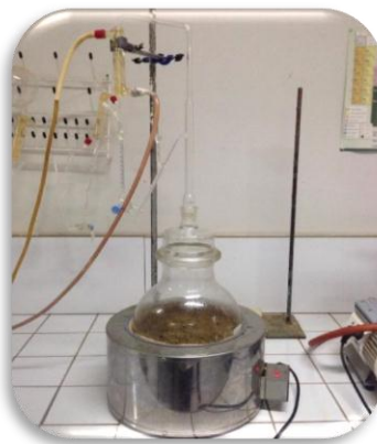
Figure 17. Montage d'hydrodistillation de type Clevenger.
