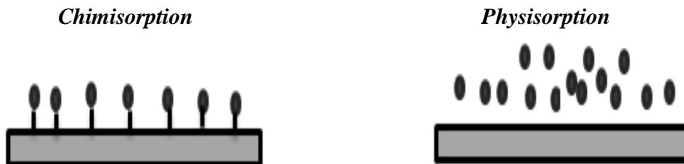
Figure I.21: Types d'adsorption : Chimisorption et physisorption
