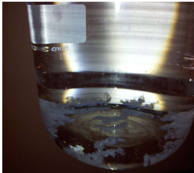
Figure III.3.5 : Eau traitée par coagulation-flocculation en utilisant le poly(AM-4VP)
