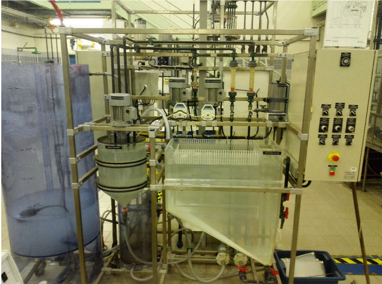
Annexe 02 : Pilote Semi-Industriel de la coagulation/floculation
