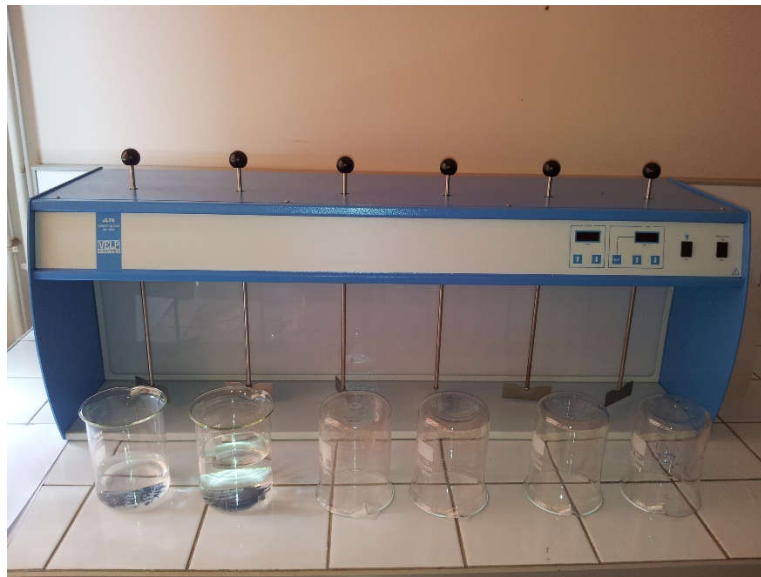
Figure II.16 : Jar-test utilisé pour la coagulation-floculation-décantation
