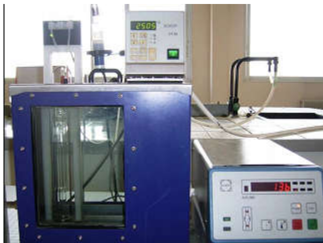
Figure II.2 : Viscosimètre à capillaire utilisé type Ubbelohde
