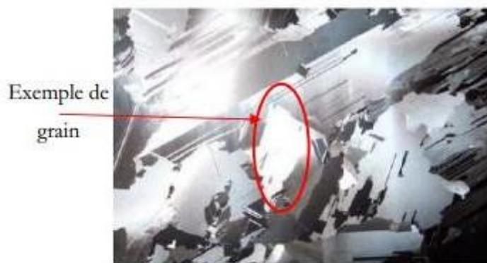
**Figure I-5** : Photo d'un substrat de silicium polycristallin (échelle : 10×10 cm<sup>2</sup>) [13].
