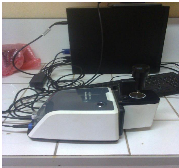
Figure 2 : Appareil infrarouge à transformé de Fourier.
