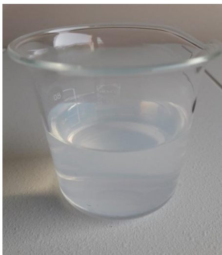
Figure IV.25 : Formation du complexe insoluble (trouble) lors de l'ajout de QP4VP à la NaCMC à pH=10 et à T=25°C
