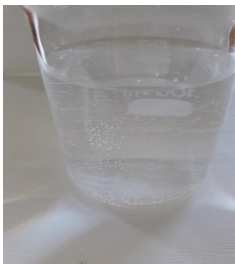
Figure IV.28 : Formation du complexe insoluble (précipité) lors de l'ajout de QP4VP à la NaCMC, à pH=5 et T=25^{\circ}C
