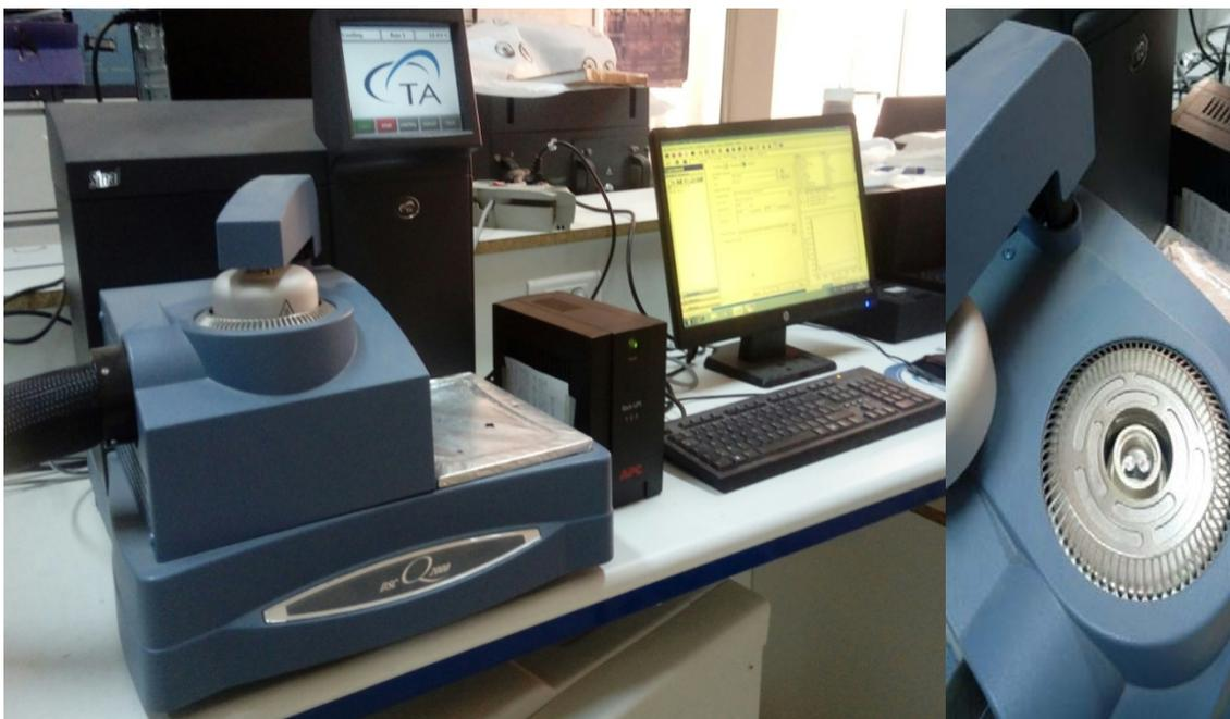
**Figure III.18:** Dispositif de mesure pour l'analyse enthalpique différentielle.
