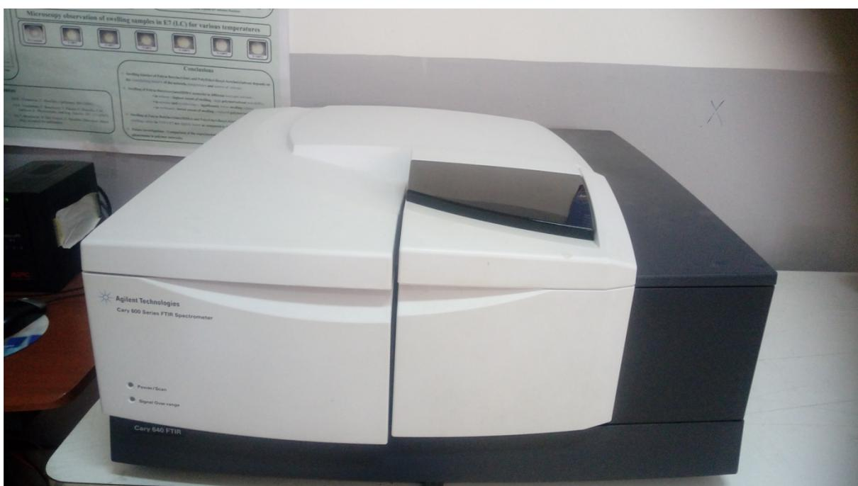
**Figure II.5 :** Spectroscopie Infrarouge à Transformée de Fourier (FTIR) à ATR
