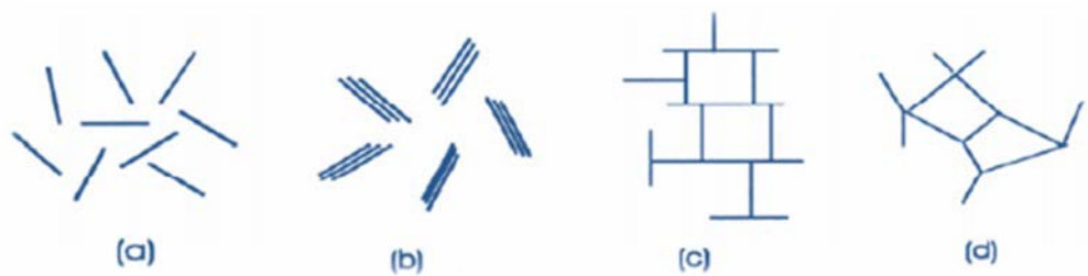
Figure 8: Modes d'associations supposés des feuillets de montmorillonite en suspension selon la théorie de Van Olphen (1964): (a) dispersion, (b) agrégation face-face, (c) association bord-face, (d) association bord-bord [15].
