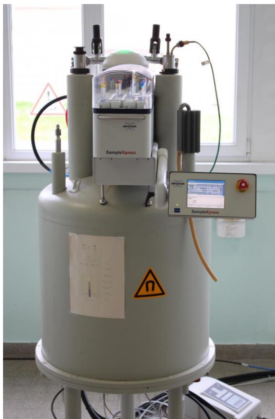
Figure 2-4:Spectromètre RMN 300Hz pour la détection de structure chimique
