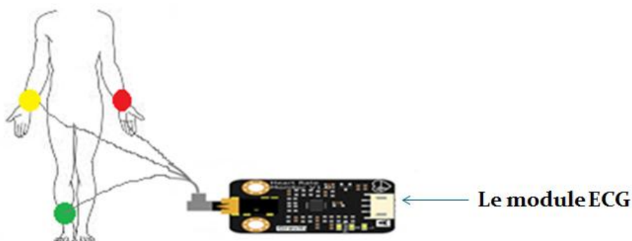
Figure II.8 : connexion de la carte ECG avec le patient et la carte d'acquisition
