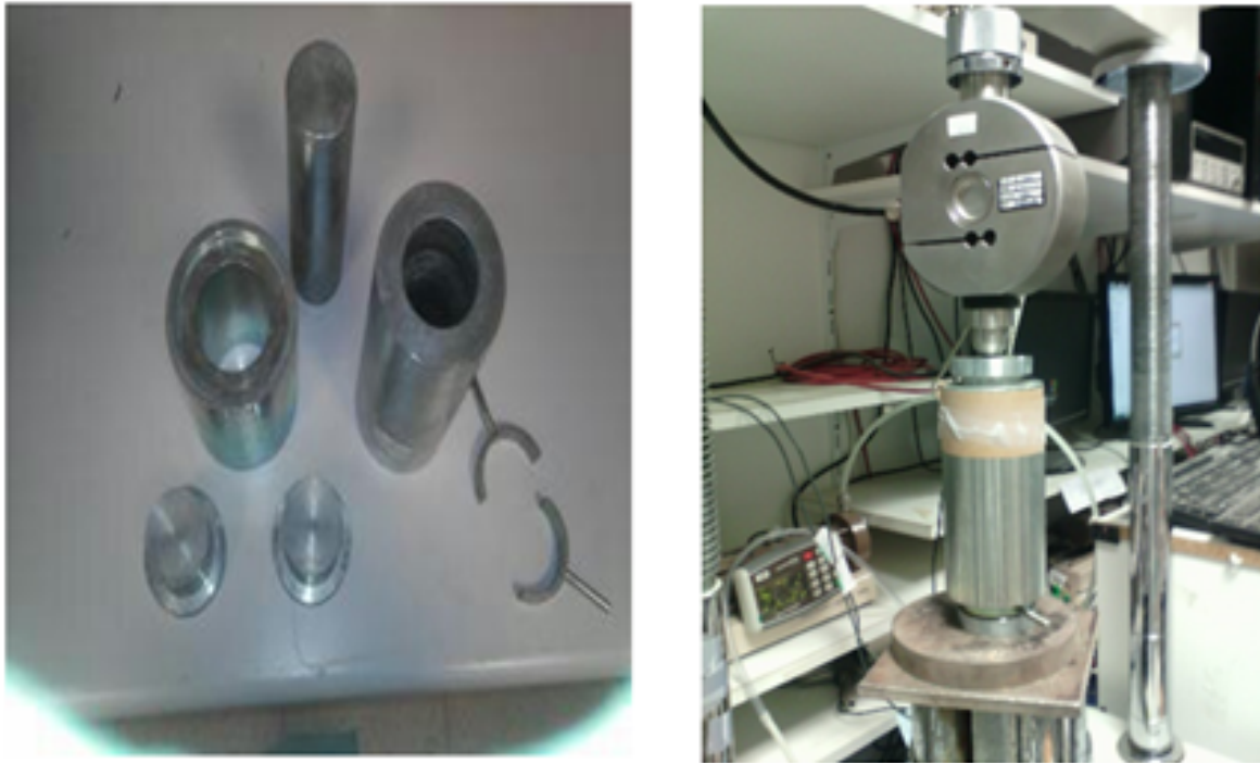
(a) les équipements de compactage statique des échantillons étudiés.
