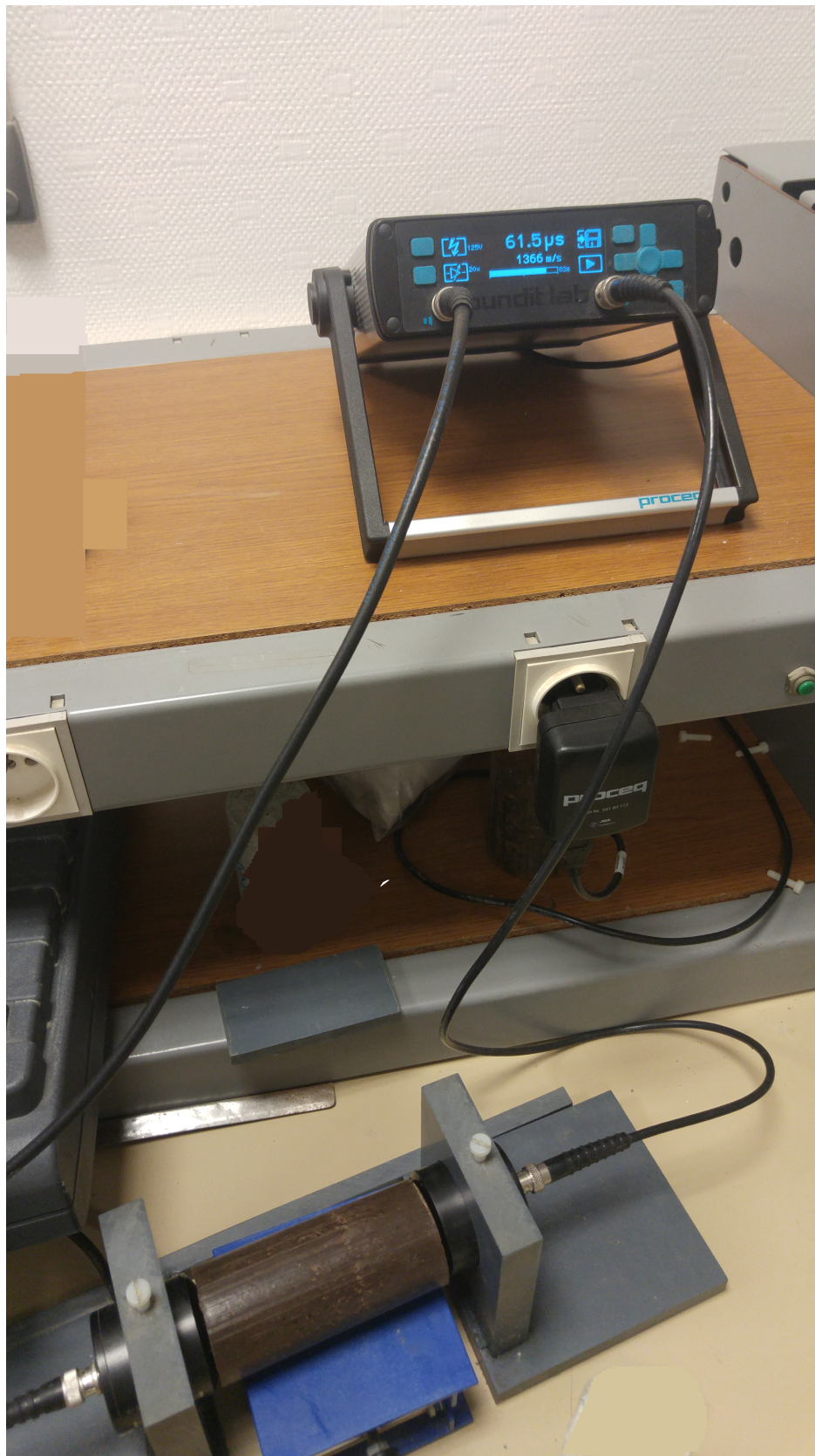
FIGURE 5.7 – Dispositif de mesure du module en petite déformation (vitesse des ondes sonores).
