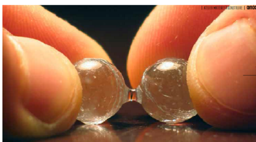
(b) Une goutte d'eau placée entre deux billes forme un pont capillaire.
