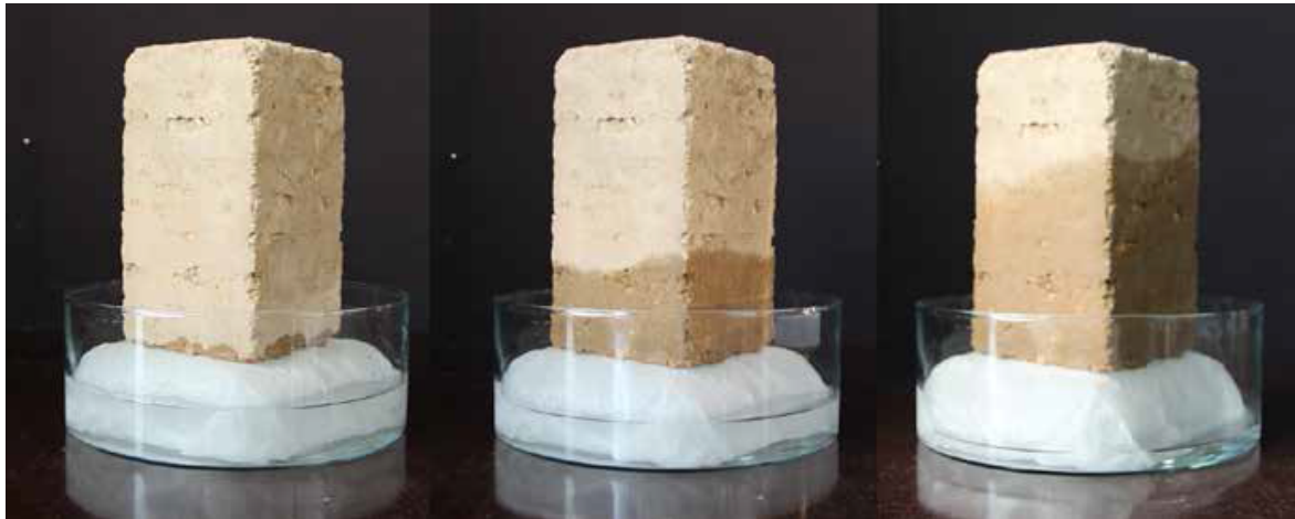
FIGURE 3.9 – Placé au contact d'un tissu humide, ce bloc de pisé se charge d'eau. Au bout de 24h, [Couvreur, 2014].
