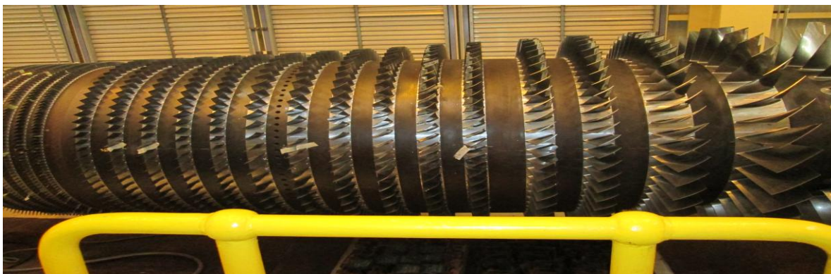
Figure (II. 3) Rotor de compresseur MBA80 [7]
