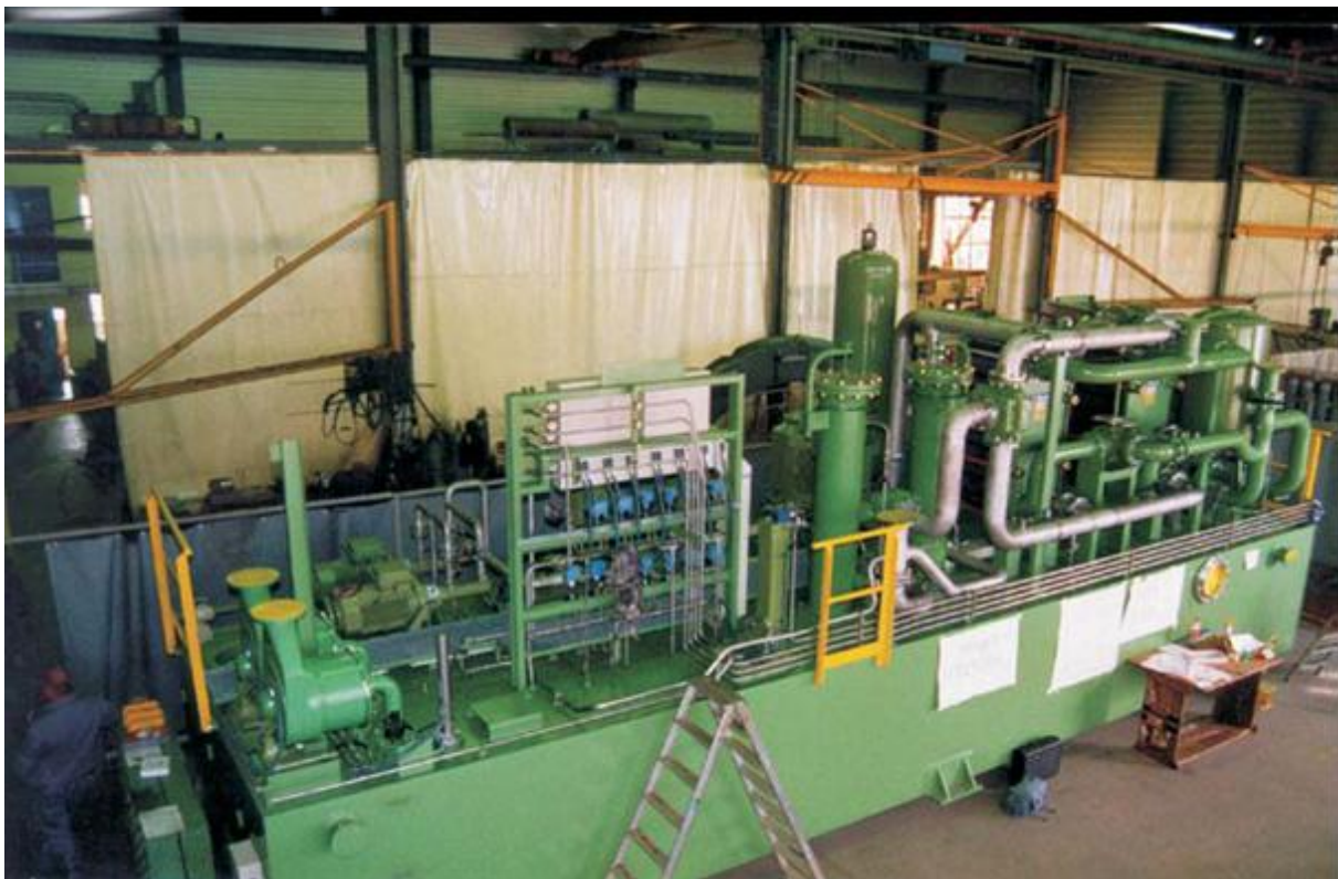
Figure (II. 30) Système d'huile de graissage [13]
