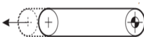
Figure II.15 : Dispositif de reprise de tension à vis
