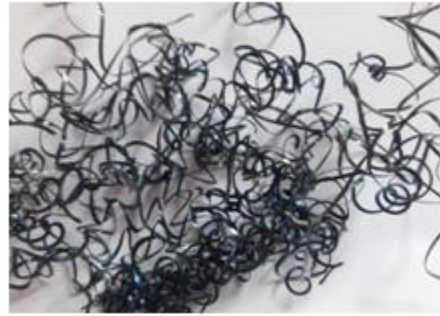
(e) : V_c=130\text{ m/min} p=0.5\text{mm} a=0.8\text{mm/tr}
