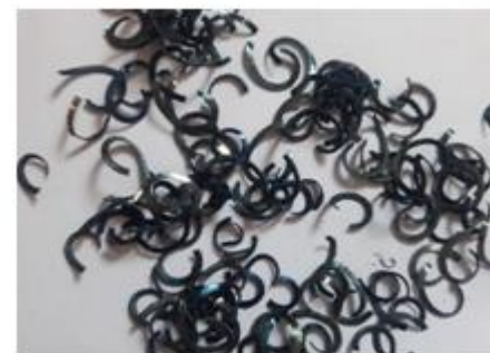
(i) : V_c=90\text{m/min} p=0.5\text{mm} a=0.4\text{mm/tr}
