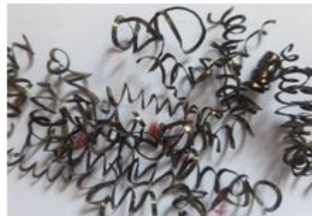
(g) : V_c=130\text{ m/min} p=1.5\text{mm} a=0.4\text{mm/tr}
