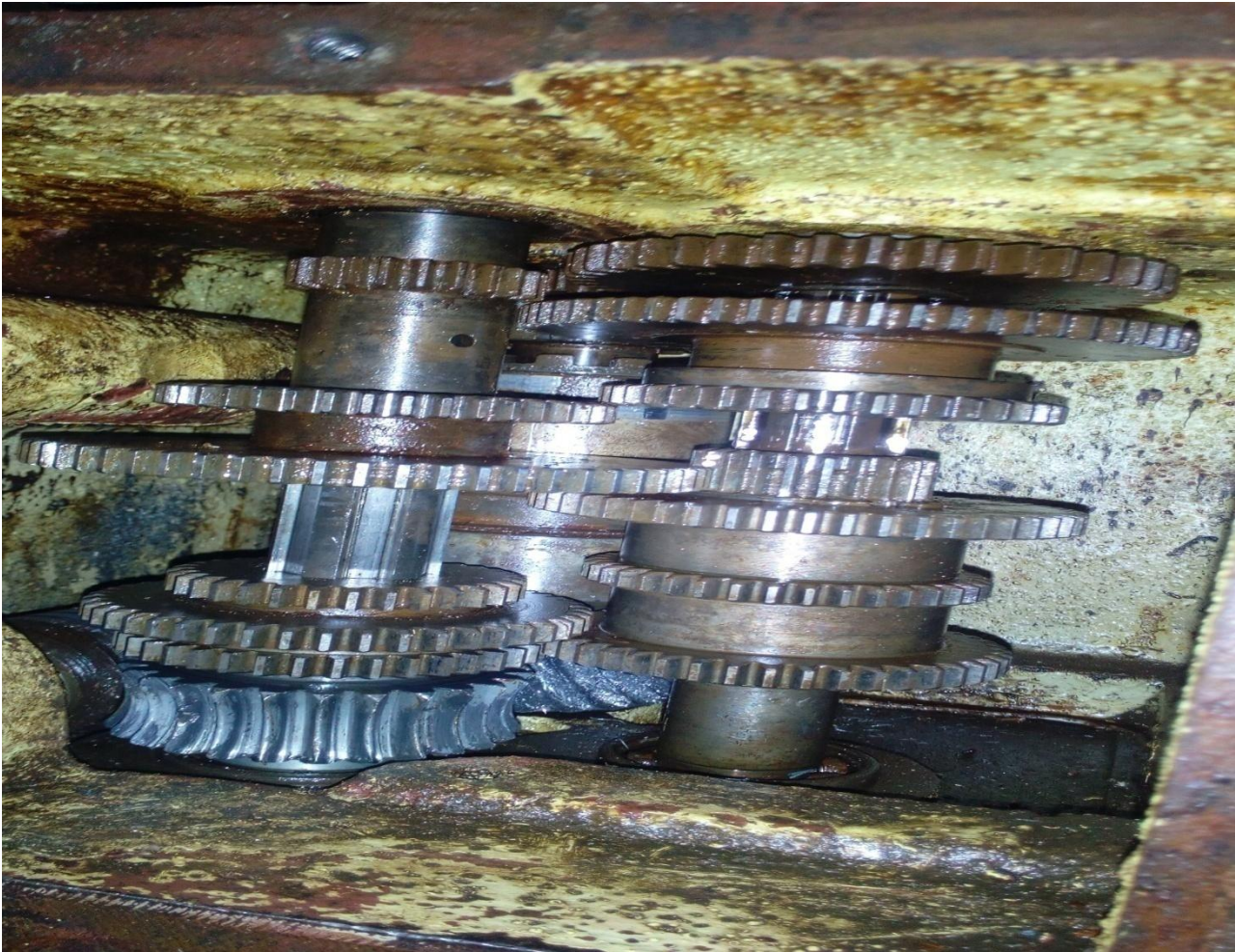
Figure IV.1 Système d'engrenage de la boîte des avances
