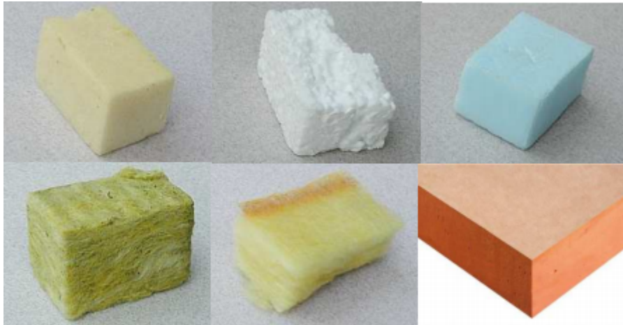
Figure 3. 7: De gauche à droite : mousse de polyuréthane, mousse de polystyrène expansé, mousse de polystyrène extrudé, laine de roche, laine de verre, mousse résol [29]
