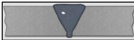
Figure III.23 : Inclusions de cuivre.
