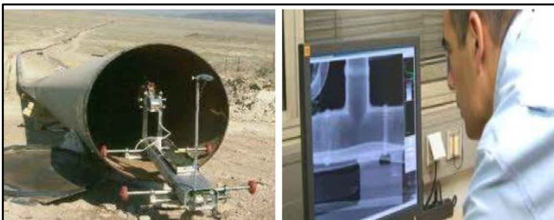
Figure III.43 : Principe de contrôle par radiographie [58].
