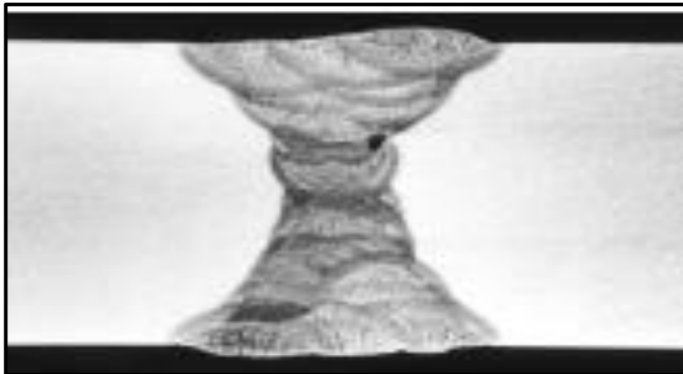
Figure III.21 : Inclusions de laitier.
