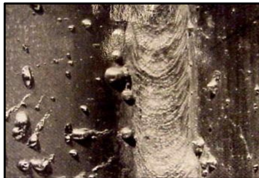
Figure III.30 : Projections sur le métal de base [33].
