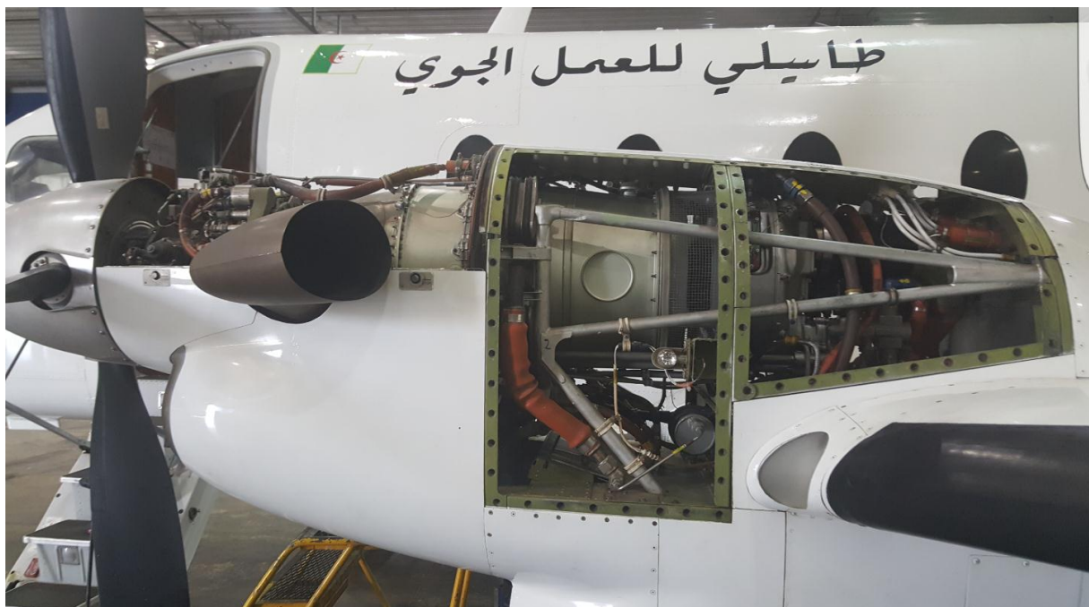
Figure 4.3 : Le turbopropulseur PT6A dans le hangar maintenance TAL
