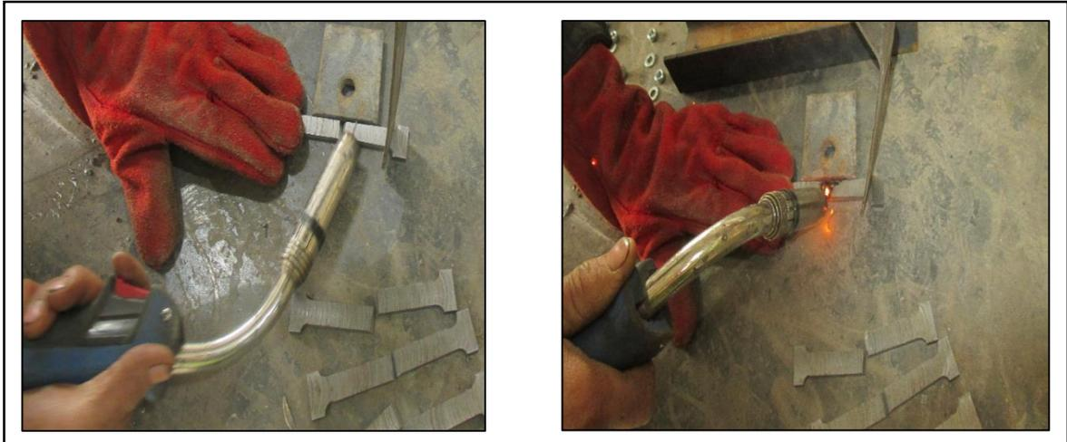
**Figure 2.20:** 1<sup>er</sup> passe de soudage.
