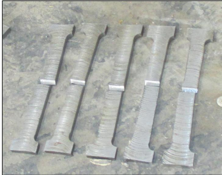
**Figure 2.14:** les éprouvettes après la coupe.
