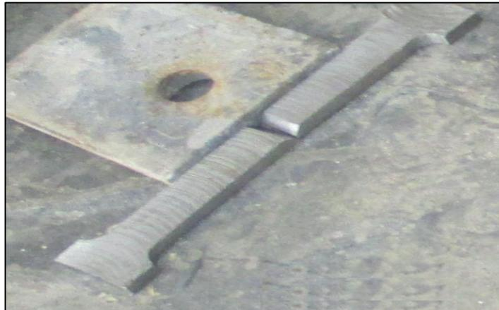
Figure 2.18: l'éprouvette après l'usinage des chanfreins.
