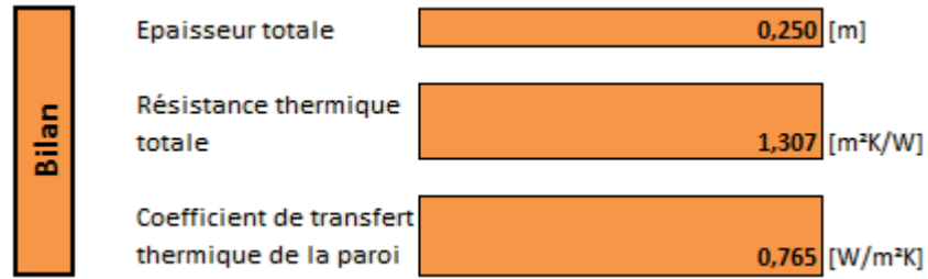
Figure III.11: caractéristiques thermique murs extérieurs [7]
