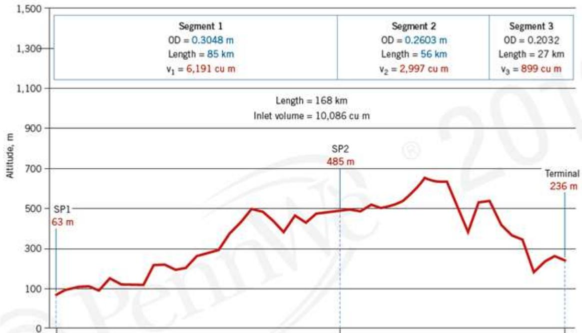
Fig. 2. 3 Profil altimétrique du pipeline multiproduit [1, 31]
