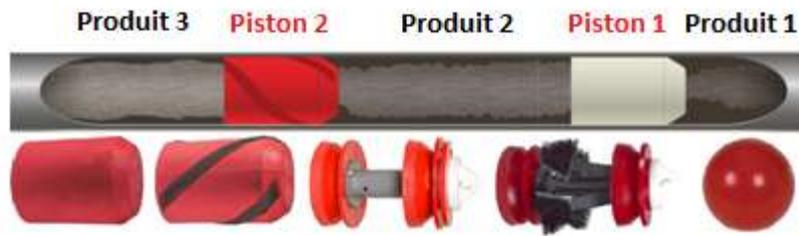
Fig. 2. 1 Ecoulement multiproduit avec des séparateurs (Pistons racleurs)
