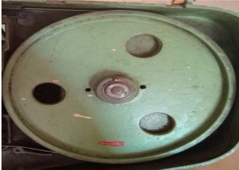
**Figure III.18** Roue motrice de scie
