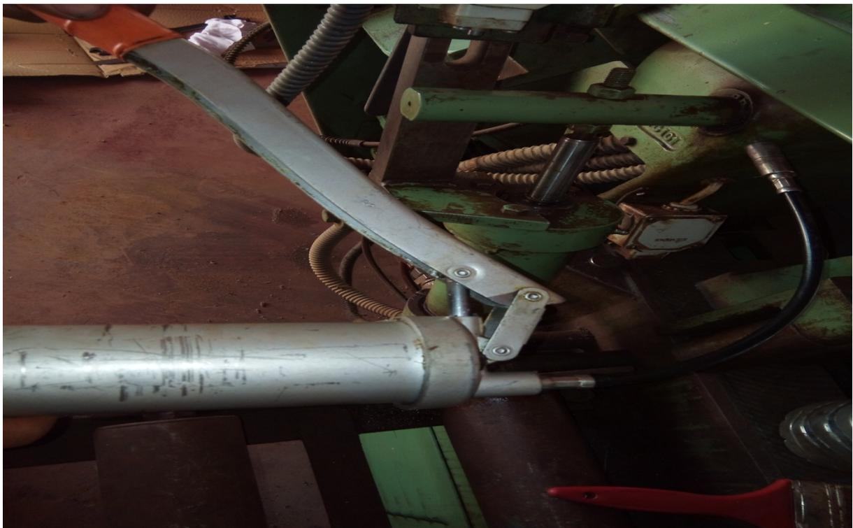
**Figure IV.13** Graissage de système d'articulation de l'arceau de scie
