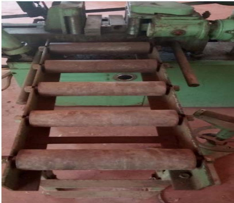
**Figure III.21** Convoyeur à rouleaux cylindriques
