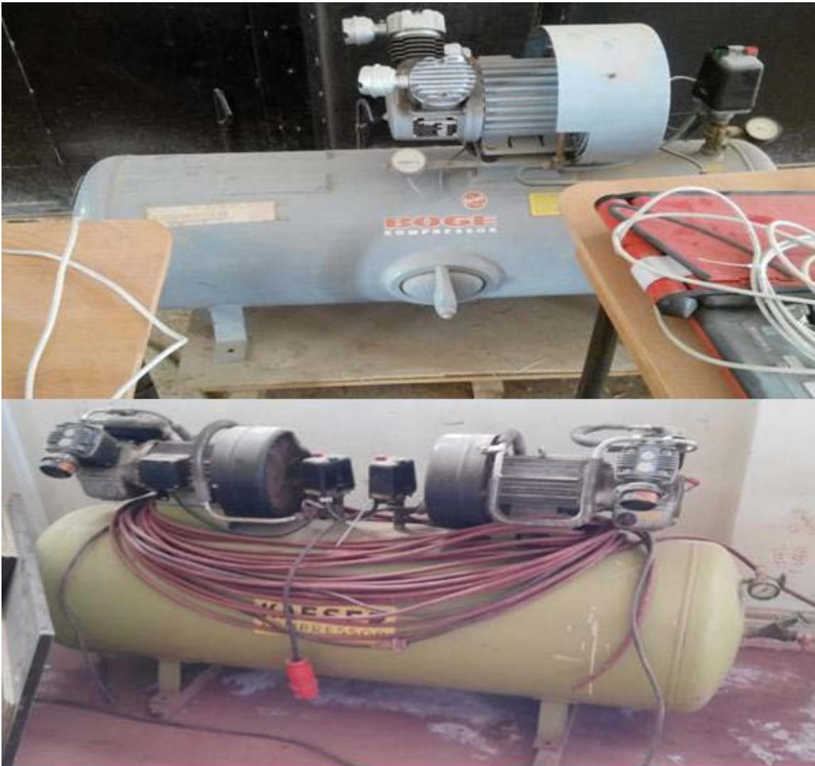
**Figure I.15** Compresseurs à pistons
