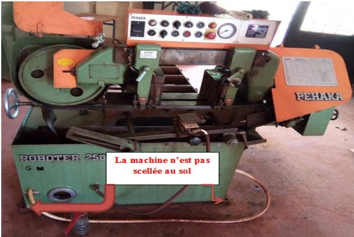
Figure III.4.3 - Machine non scellée au sol.
