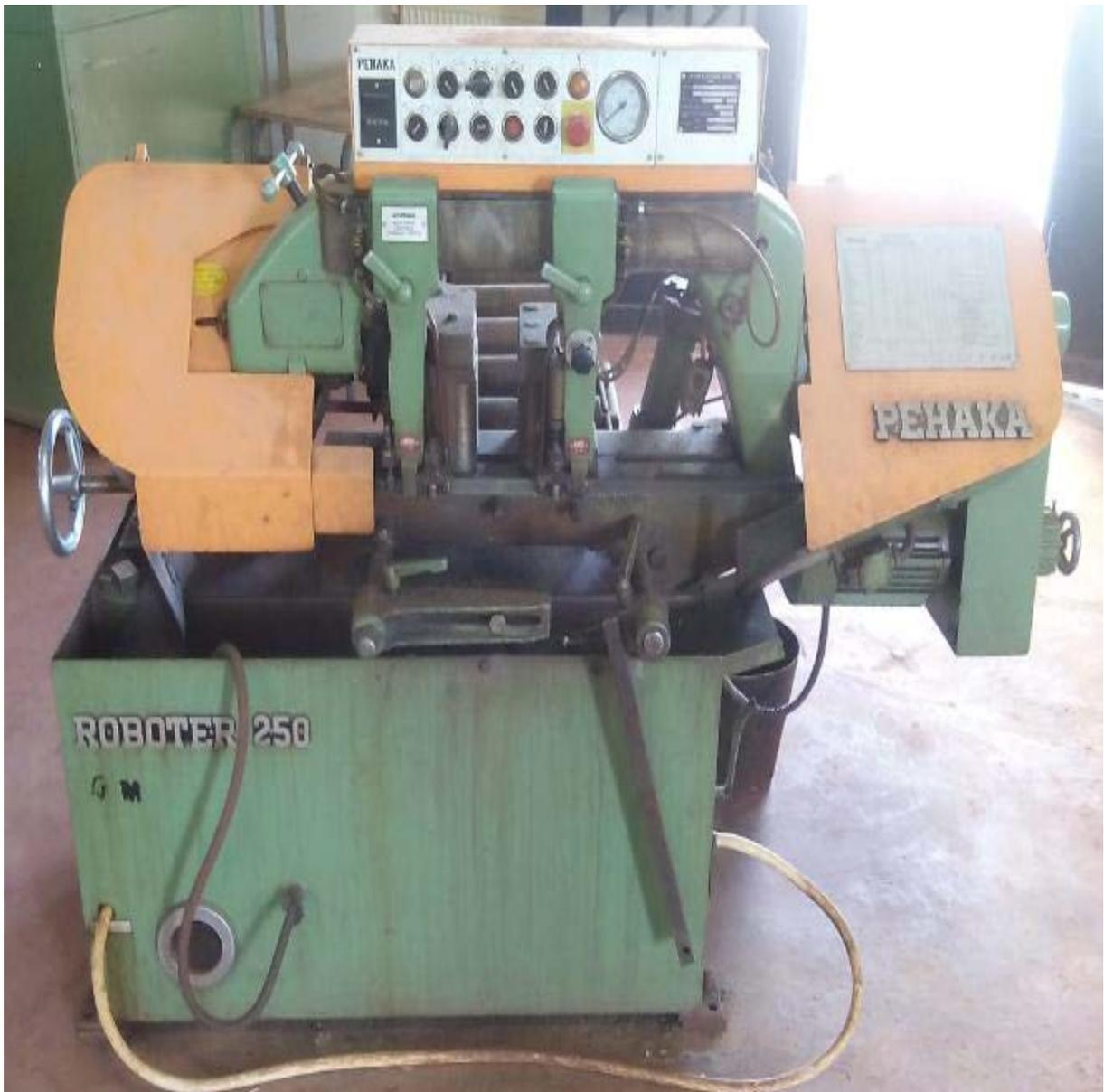
**Figure I.12** Scie à ruban PEHAKA ROBOTER 250 SL
