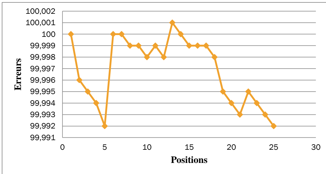
Figure 3.4. Défaits de la trajectoire de l'outil de coupe « deuxième essai »
