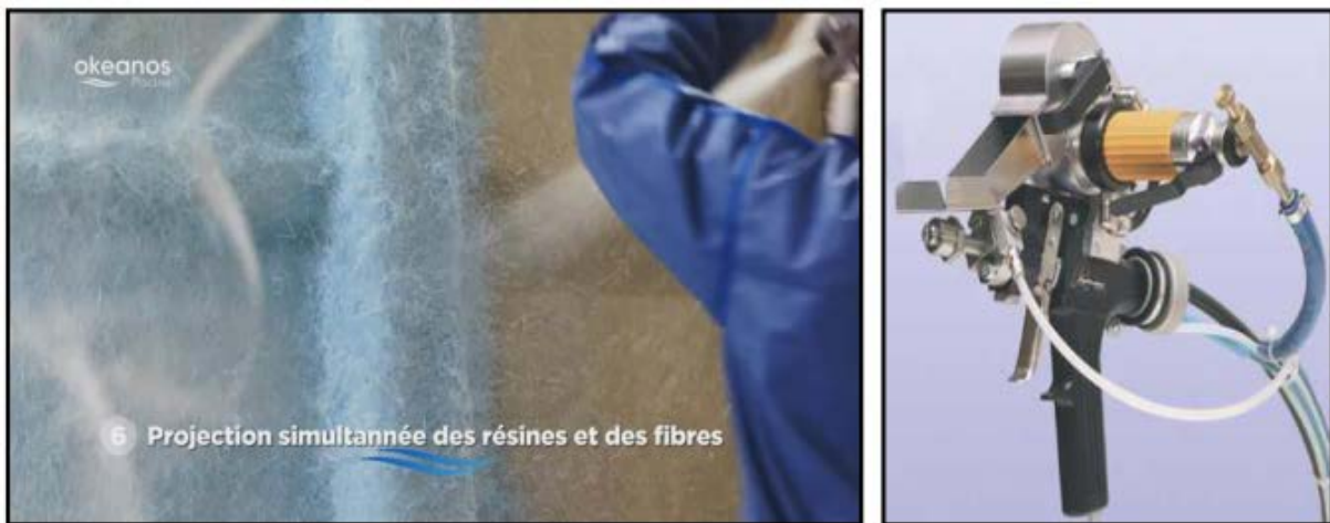
Figure I.12 : Principe du moulage par projection simultanée (Source Okeanos-France : fabrication d'une piscine).
