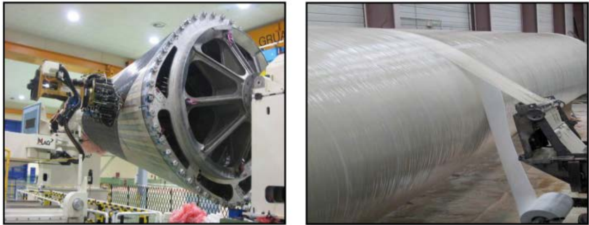
Figure I.20 : Principe du moulage par enroulement filamentaire (source site CNES).
