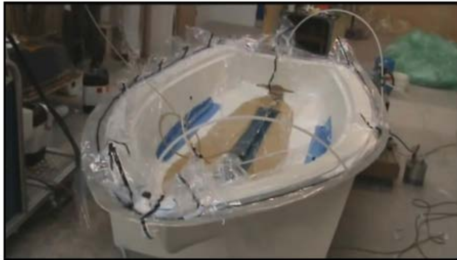
Figure I.13 : Principe du moulage sous vide (source Marine Innovation Service).
