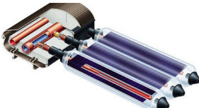
Figure 1-14 : capteur à tubes sous vide à flux direct [19]
