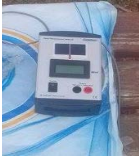
Figure 3-14 : photo graphie du solarimètre
