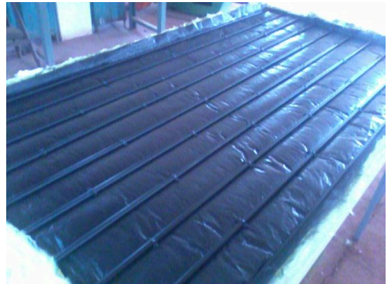
Figure 3-8 :le plaque en aluminium avec peinture et l'échangeur
