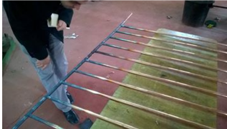
Figure 3-1: Réalisation de l'échangeur
