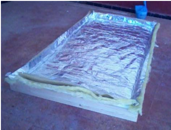
Figure 3-7: la plaque en aluminium sans peinture.
