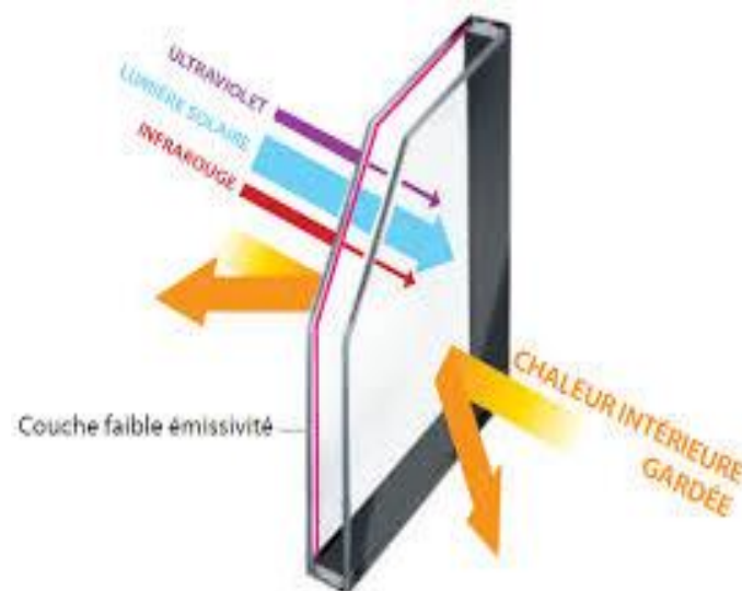
Figure 3. 12 : Description de la fenêtre [47]
