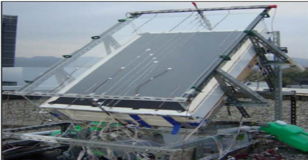
Figure 2. 28 : Photo réelle de la cheminée solaire [36]
