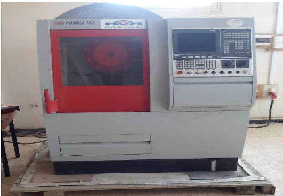
**Photo I.3** fraiseuse numérique PC MILL 155
