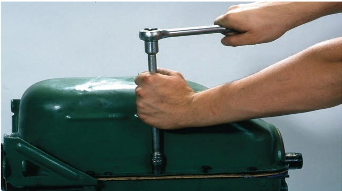
**Photo IV.6** resserrage des vis et des écrous
