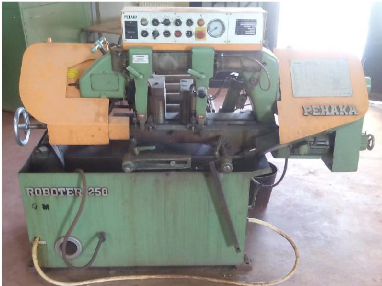
**Figure I.11.** Scie à bande PEHAKA ROBOTER 250
