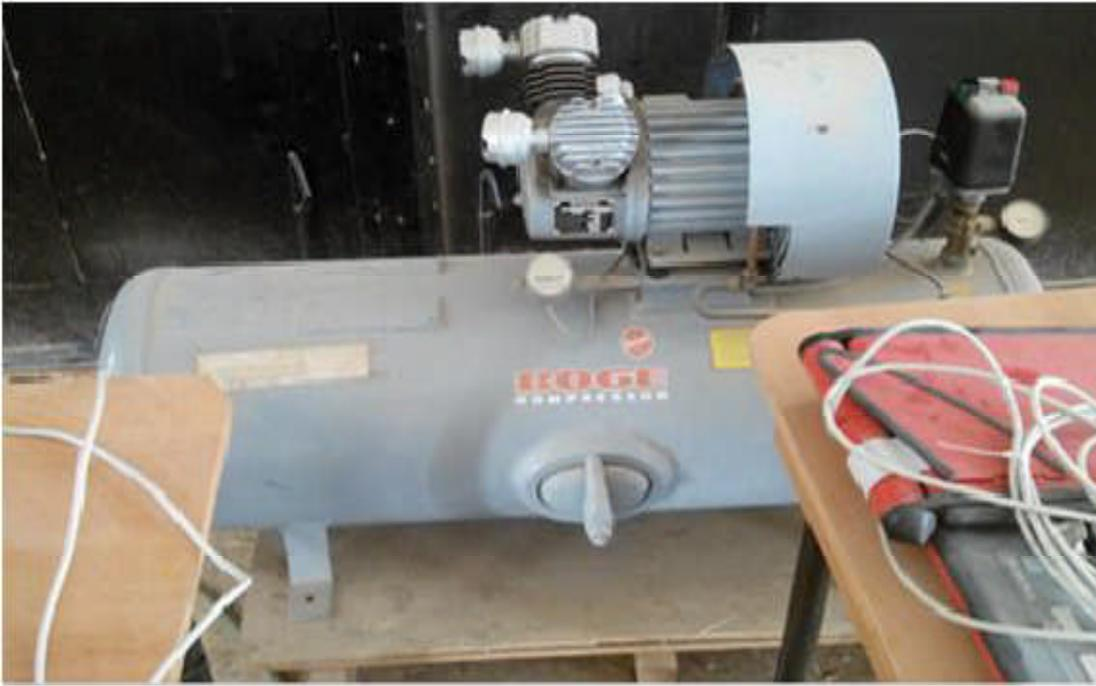
**Figure I.14 b** compresseurs BOGE SBD 250 litres
