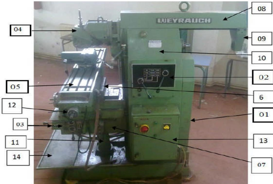
**Figure II.8 :** Principaux organes de la fraiseuse
